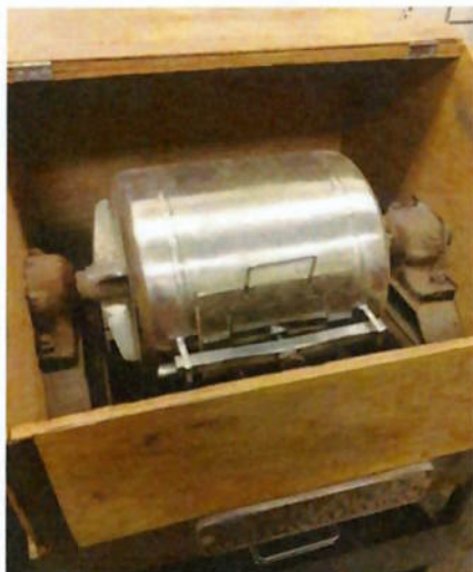
Figura 5 - Ensaio de Bond: Moinho de bolas
